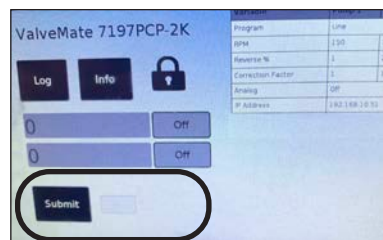
Écran principal (Main) lorsque la fonction de verrouillage / déverrouillage est activée et que le système est verrouillé ; un mot de passe est requis
