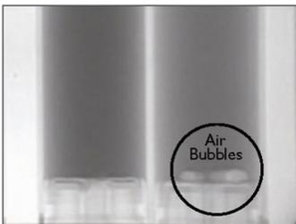
Röntgenaufnahme einer Kartusche mit Luftpneinschlüssen
