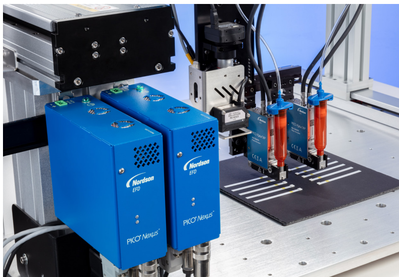
小巧的外形便于在DIN导轨上安装多个控制器。
